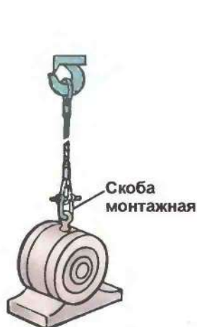
СТРОПОВКА ЭЛЕКТРОДВИГАТЕЛЯ ДВУХПЕТЛЕВЫМ СТРОПОМ
