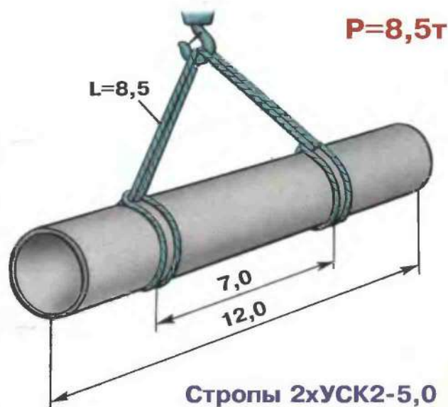
4. Железобетонная оболочка диаметром 0,6 м
